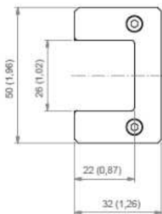
Figura 2.17 – Dimensionales y montaje de los modelos de imanes lineales.
